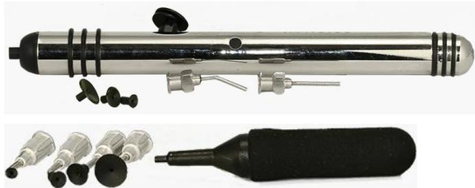
吸引ピックアップツールは軽量でフラットな試料に手を触れずに、また、シャープなピンセットなどを使用しないで持上げるデリケートで表面を傷つけない試料に理想的なツールです。カバーガラス、Si 基板、石英基板、小さな部品等のサンプルに使用することができます。吸引ピックアップツールの吊上げ能力は、以下に依存します。
