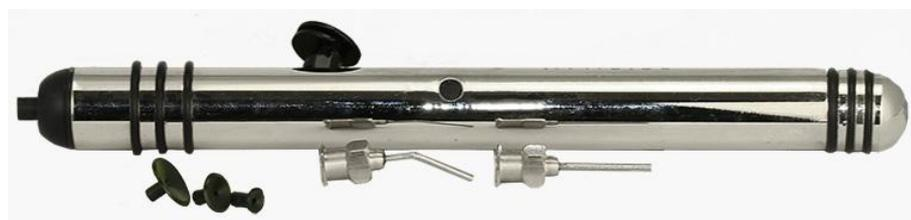
ピストン式ペン型ピックアップツール(スイス製)はマニュアル操作が簡単で、電源は不要です。基板、カバーガラス、フラットで小さな部品などの部品をピックアップするのに理想的なツールです。完全に導電性の金属と ESD 上、安全なプラスチック部品で構成されています。ペン型ボディーと 1 本のストレートチップ、1 本の 45° の角度付チップとサイズの異なる 3 個の吸引カップで構成されています。チップは外径 1.3 mm (18 ゲージ) と長さは効果的な 20 mm サイズです。カップはチップ先端に取付ける 4、6 および 9 mm 径が付属しています。高性能なピストン作動ポンプは、優れた吸引性能を保証します。また、ガラス小瓶入り真空グリースが試料には触れないピストン部のメンテナンス用に付属しています。
